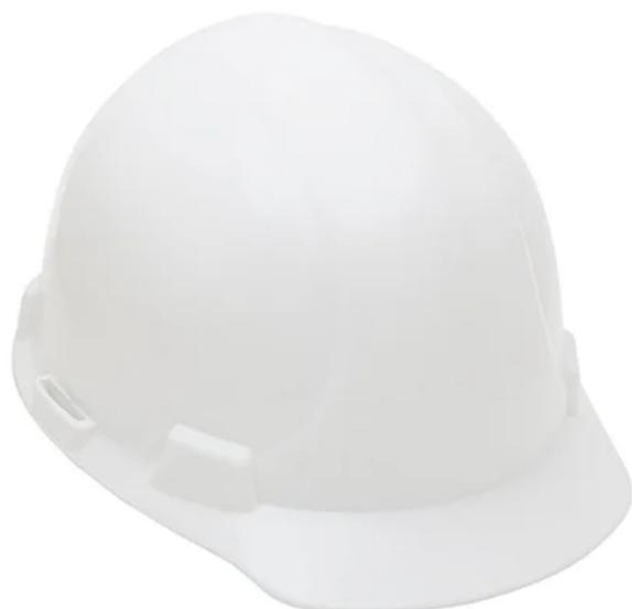
Capacete de segurança, tipo II, com aba frontal, classe b, suspensão injetada em plástico, com regulagem através de ajuste simples e tira absorvedora de suor, possui fendas laterais para acoplagem de acessórios -protetor auditivo e protetor facial -com ou sem jugular ajustável. Proteção da cabeça do usuário contra impactos de objetos sobre o crânio e contra choques elétricos.
