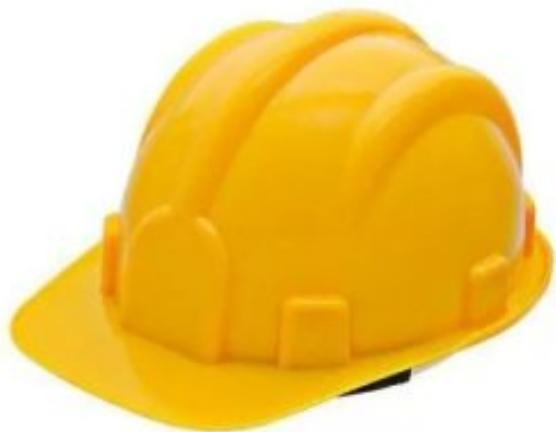
Capacete de segurança Tipo II com aba frontal classe B casco com três nervuras, com fendas laterais para acoplamento de acessórios (protetor facial ou auditivo), com suspensão fixa ao casco através de oito pontos de encaixe, regulagem de tamanho através de ajuste simples e tira absorvedora de suor em espuma coberta de material sintético com ou sem jugular ajustável, confeccionada em tira de tecido sintético e fixa na carneira e/ou separada com fechamento simples ou velcro.
