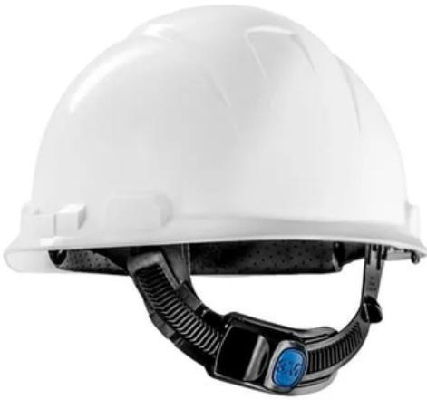
Capacete de segurança Classe B, com casco de aba frontal tipo II, moldado em polietileno de alta densidade na versão sem ventilação. Suspensão com quatro ou seis pontos de fixação, confeccionada com duas ou três tiras de tecido, carneira em polietileno de alta densidade, com regulagem através das suspensões Ajuste Simples, Catraca, Ajuste Fácil ou Secure Fit.
