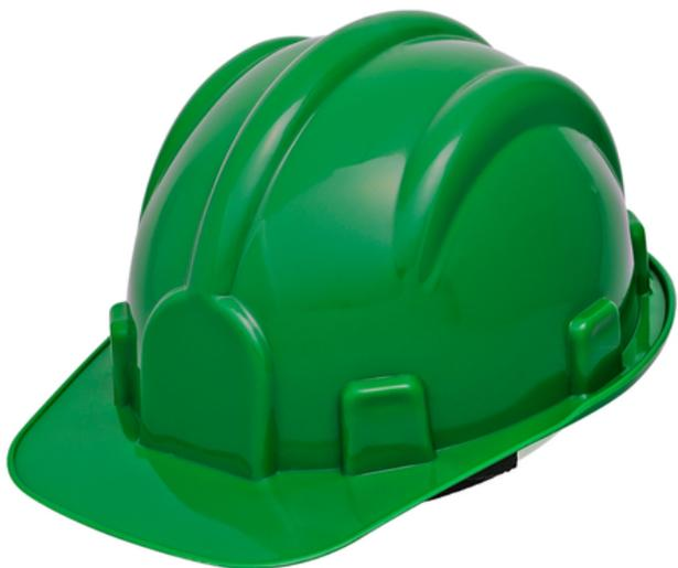
Capacete de segurança Tipo II com aba frontal classe B casco com três nervuras, com fendas laterais para acoplamento de acessórios (protetor facial ou auditivo), com suspensão fixa ao casco através de oito pontos de encaixe, regulagem de tamanho através de ajuste simples e tira absorvedora de suor em espuma coberta de material sintético com ou sem jugular ajustável, confeccionada em tira de tecido sintético e fixa na carneira e/ou separada com fechamento simples ou velcro.
