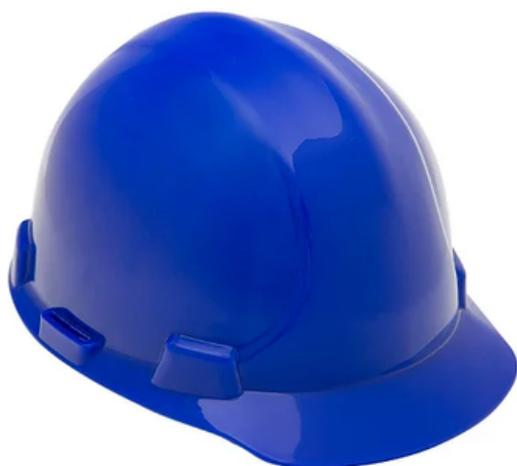
Capacete de segurança, tipo II, com aba frontal, classe b, suspensão injetada em plástico, com regulagem através de ajuste simples e tira absorvedora de suor, possui fendas laterais para acoplagem de acessórios -protetor auditivo e protetor facial -com ou sem jugular ajustável. Proteção da cabeça do usuário contra impactos de objetos sobre o crânio e contra choques elétricos.
